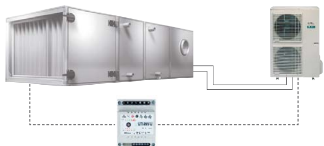
Lüftungsanlage mit INV-Modul
