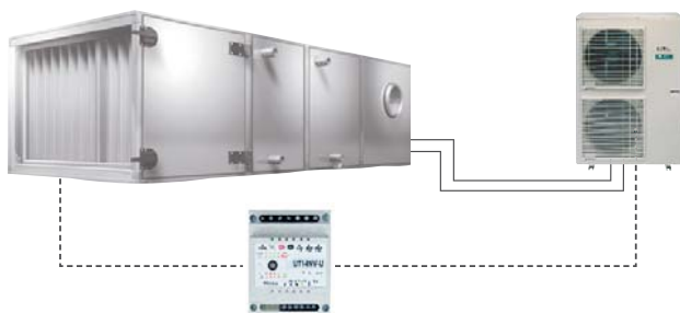
Lüftungsanlage mit INV-Modul
