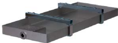
AuRü-Umweltschutzwanne gem. WHG Mit eingebautem Ölabscheider bei Außen- aufstellung, inkl. Querträger. Die Wanne ist ca. 100 mm größer als die Außeneinheit zu wählen.
